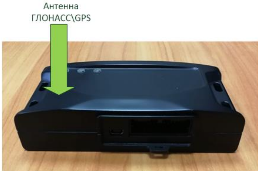
Рисунок 4.5. Ориентация FORT-114 при установке в транспортном средстве
