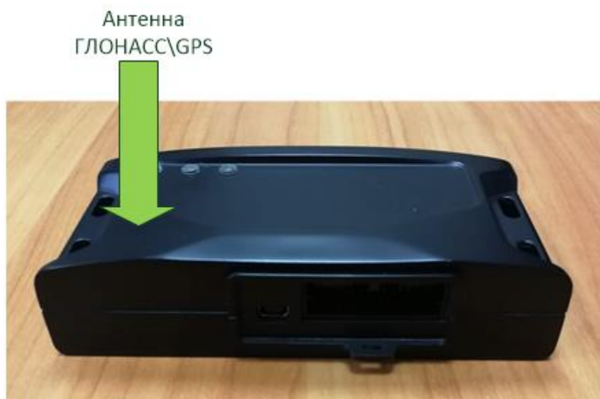
Рисунок 4.5. Ориентация FORT-112M при установке в транспортном средстве
